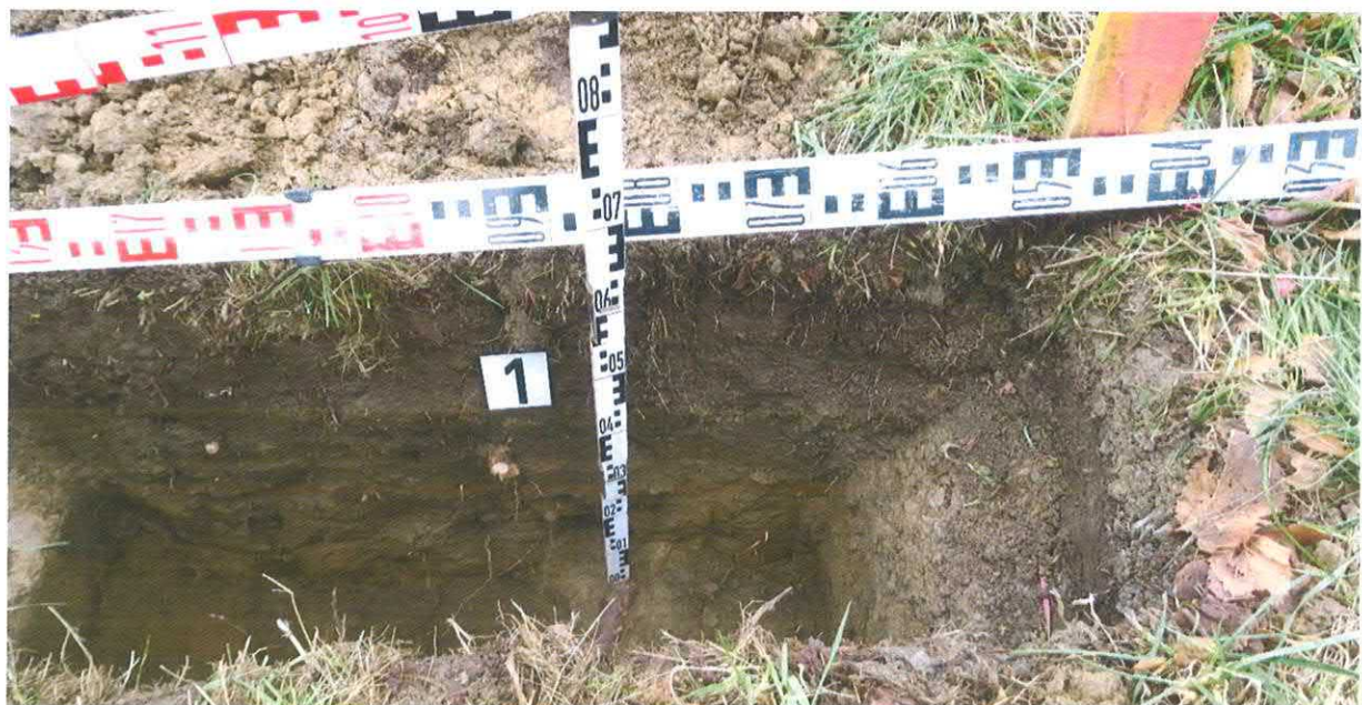
Abb. 16: Nahansicht von Osten. Nördlicher Grabungsbereich an Baum Nr. 1, angrenzend zur Straßenkante. Geringe Wurzelentwicklung bis ca. 0,60 m unter OK Gelände. Wurzelteile bis zu ca. 3 cm Durchmesser wurden bei Bedarf und zur Ausführung tiefergehender Schürfe mit glattem Schnitt an der Grabungswand abgetrennt.
